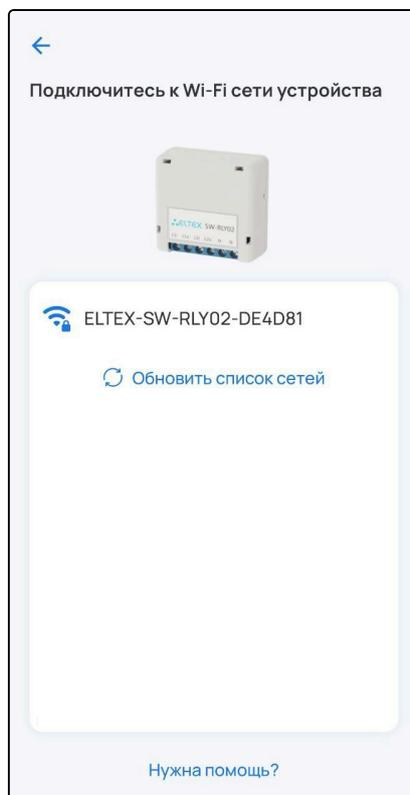
Пароль от сети **ELTEX-SW-XXXXXX** — это серийный номер добавляемого устройства, расположенный на корпусе устройства, но со вторым символом, указанным в нижнем регистре.
