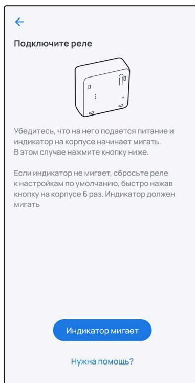
**⚠** Если индикатор не мигает или мигает медленно, нажмите на сервисную кнопку 6 раз (процедура сброса может отличаться, воспользуйтесь инструкцией из комплекта). Устройство будет сброшено и перейдет в режим добавления автоматически.
